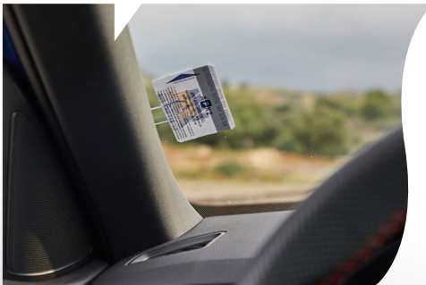
Tickethalter in der A-Säule auf der Fahrerseite
