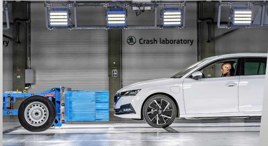
Heute betreibt ŠKODA AUTO ein eigenes Crashlabor, in dem zwei frontal aufeinander zufahrende Fahrzeuge auf bis zu 65 km/h beschleunigt werden können und ein einzelnes Fahrzeug eine Geschwindigkeit von bis zu 120 km/h erreicht.
